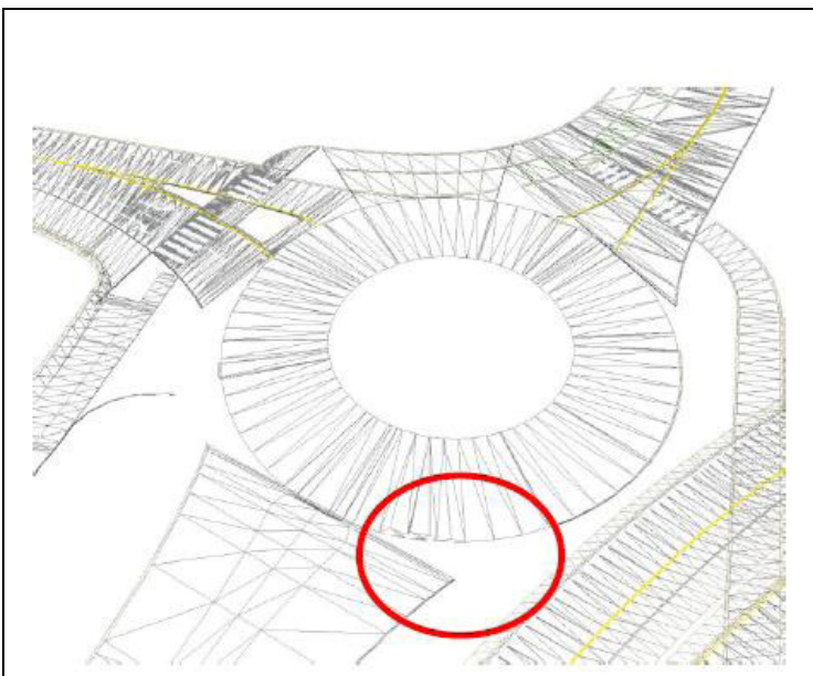
Joonis 8. Teepinnamudelite puhul (v.a ülemine koondpind) on lubatud mittejätkuvused teede liitumis- ja ristumiskohtades
