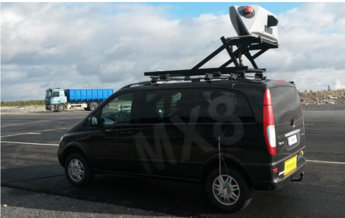
Joonis 2-2. Kaubikule paigaldatud laserskaneerimissüsteem
