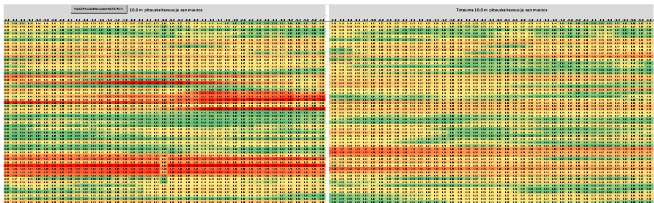
Joonis 2-18. Pikisuunalisel laserskaneerimisel saadud teostusandmete võrdlemine ja visualiseerimine Excelis
