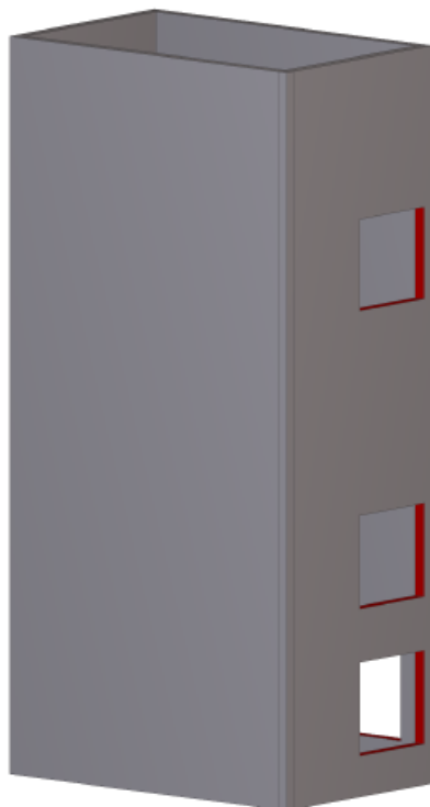
Joonis 2. Trepišahti mudeli täpsuse näide eelprojekti staadiumis. Joonis: Finnmap Consulting Oy.
