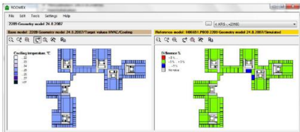
Joonis 6. Sisekliima simulatsiooni tulemuste kasutamine mudelipõhises rakenduses (RoomEx), mis võimaldab analüüsi tulemusi ja eesmärgi visuaalselt võrrelda.
